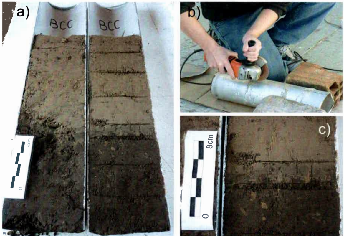
Figura 6.3. Submuestreo de columnas de suelo. a) Perfil de la columna de suelo, b) apertura de la columna, c) detalle de los cambios de color, textura y estructura del suelo.
