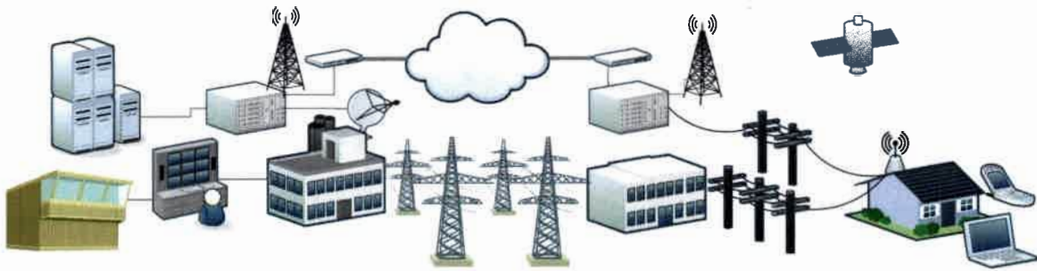
Figura II-1: Smart Grid: infraestructura eléctrica + infraestructura de comunicaciones.
