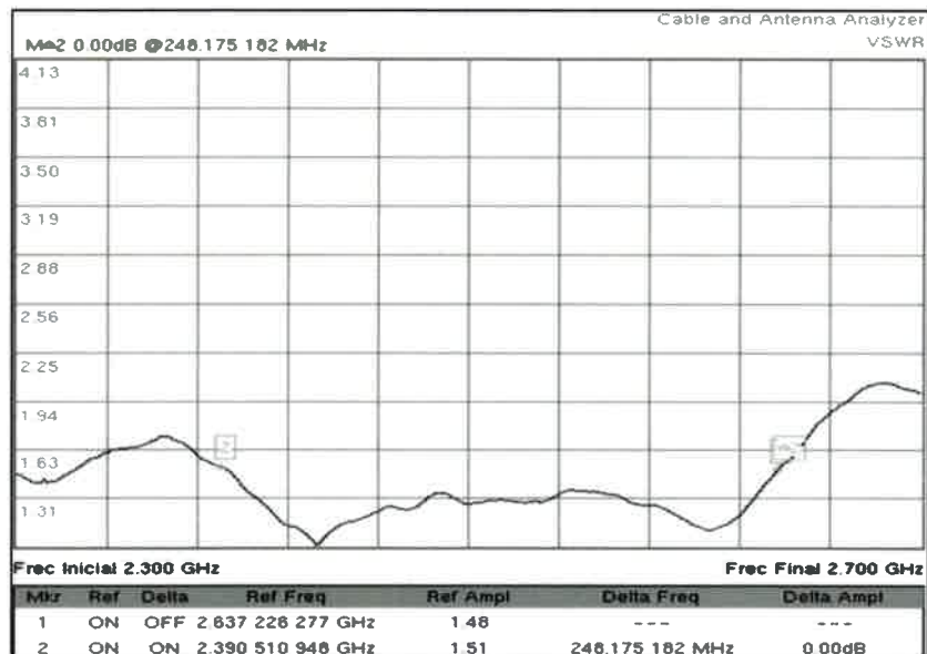
Figura V-18: Medición de Frecuencia vs. ROE.
