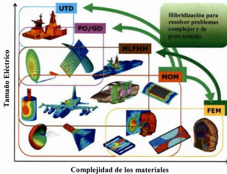
Figura IV-18: Áreas de aplicación de los diversos métodos numéricos [51].
