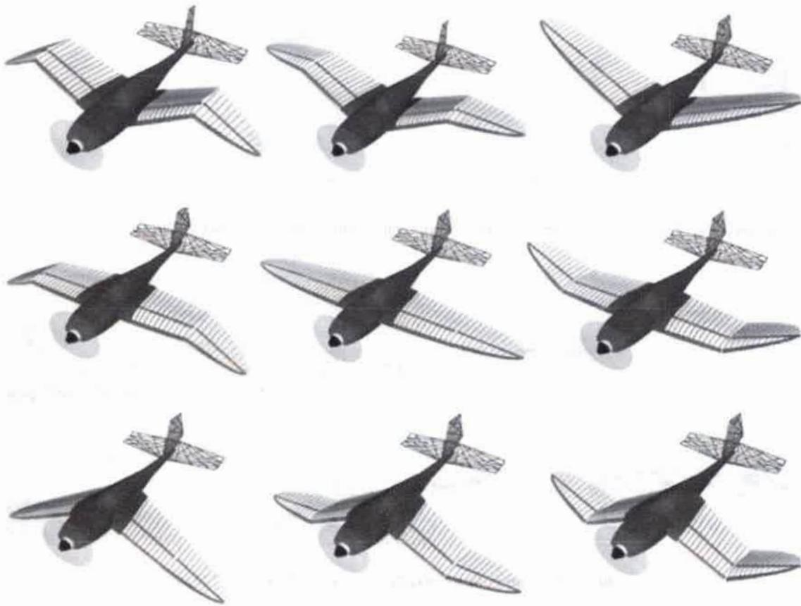
**Figura 1-6: Configuraciones de un UAV con alas flexibles inspirado en las gaviotas [36].**
