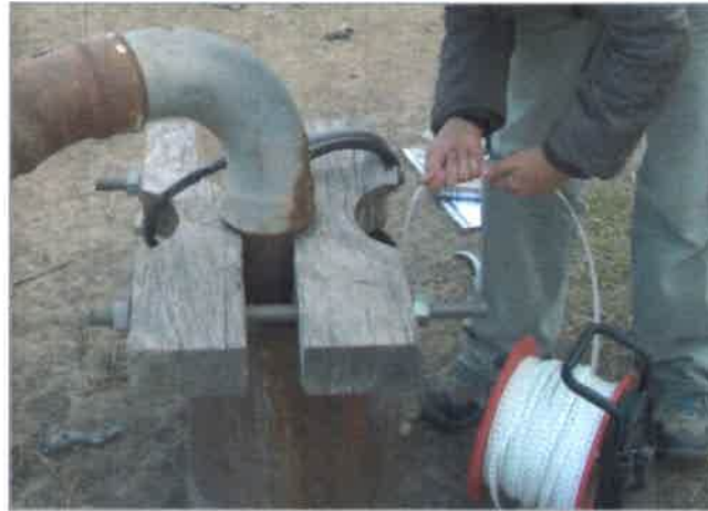
Figura 3.2. Medición del nivel freático con sonda piezométrica.
