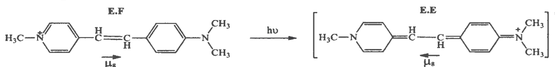
Figura 31. Localización de la carga en el estado fundamental (E.F) y el estado excitado (E.E) de HC.
