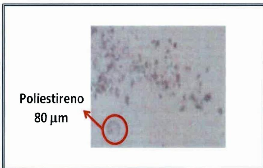
**Figura 41. Imagen de micropartículas obtenidas. Se utilizó como referencia micropartículas esféricas de poliestireno**
