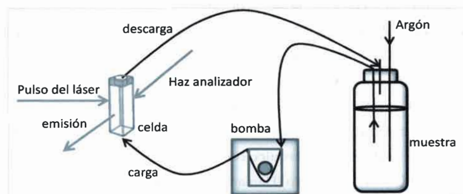
Figura II.4. Esquema del sistema utilizado para mantener flujo constante en medidas de LFF
