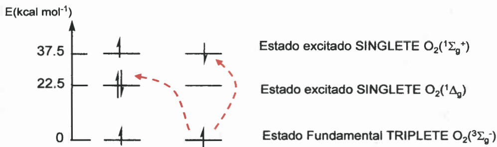
Figura I.2. Diagrama de energía para el O_2 .
