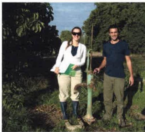
Foto 4.7. Bomba de mano sin acceso para medición de nivel de agua subterránea
