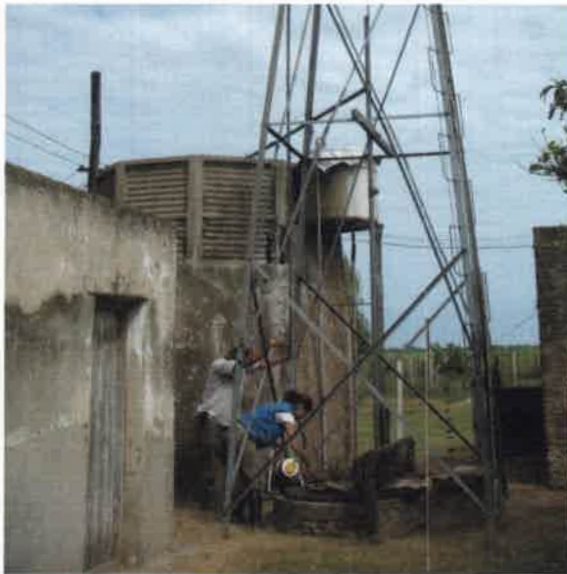
Foto 4.11. Medición de nivel de agua subterránea en molino con antepozo P2
