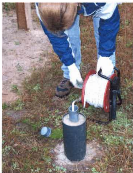
Foto 4.5. Medición de niveles de agua subterránea con sonda manual
