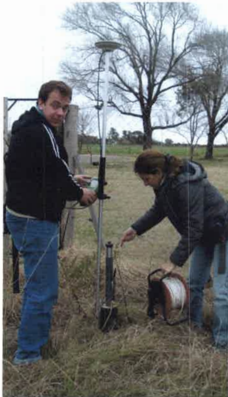
Foto 4.3. Acotamiento de boca de pozo CEM-E
