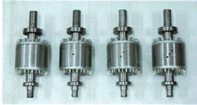
Figura B-3. Rotores con barras rotas empleados para los ensayos de laboratorio.
