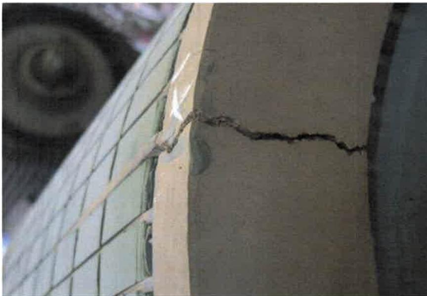
Figura D-3. *Motor B*. Detalle de la rotura del anillo de cortocircuito.
