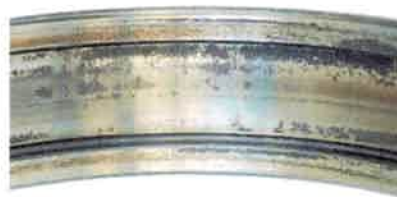
Figura II.18: Oxidación y corrosión
