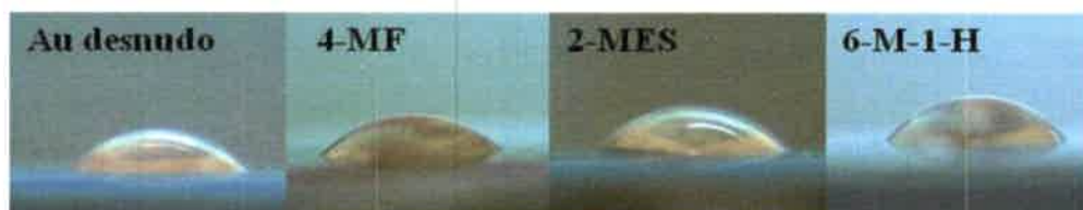
Figura 81. Imágenes de perfiles de gotas para la medición de los ángulos de contacto sobre superficies de Au desnudo y modificadas con las MAE de 4-MF, 2-MES y 6-M-1-H a pH 4.
