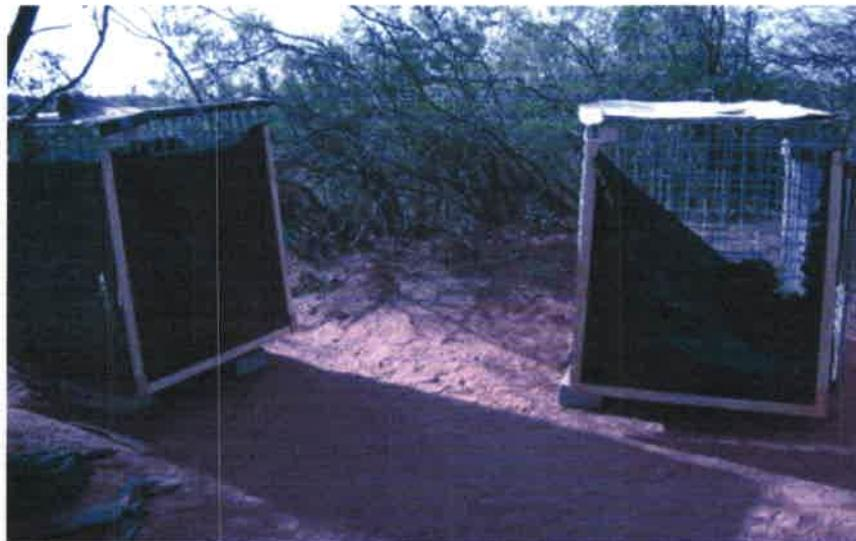
Foto 4.2. Jaulas recubiertas con nylon negro de alta densidad.
