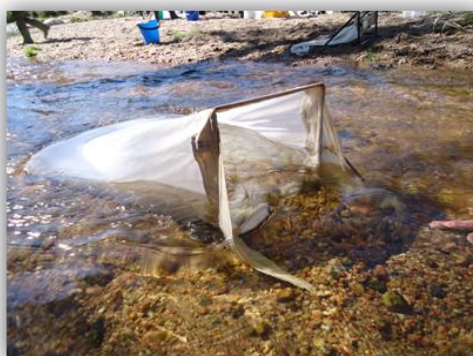
Figura 6. Red tipo Surber en el arroyo Achiras-del Gato.
