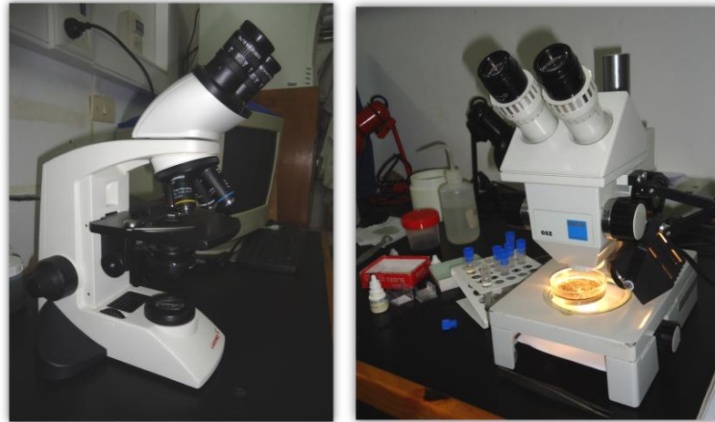
Figura 8. Estereoscópico y microscopio óptico utilizados para realizar el procesamiento de muestras en laboratorio.
