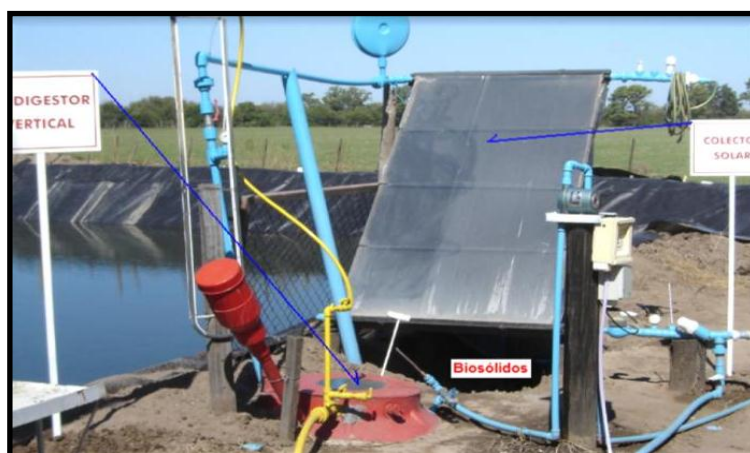
Figura 6. Proceso de biodigestión de lodos urbanos. Planta Piloto UNRC. Río Cuarto. Córdoba
