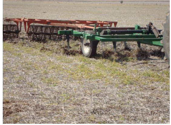
Foto 4: Vista del conjunto descompactador y rolo trabajando.
