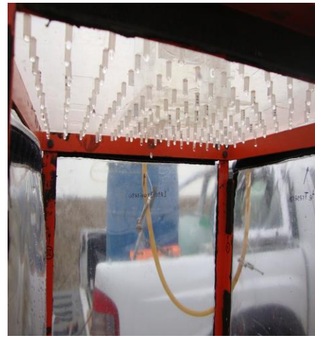
Foto 6: Detalle de la placa portagoteros del microsimulador de lluvias.
