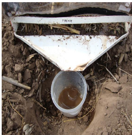
Foto 9: Vista frontal del embudo del microsimulador y del recipiente colector graduado en momentos donde está recibiendo escurrimiento (agua + sedimentos).
