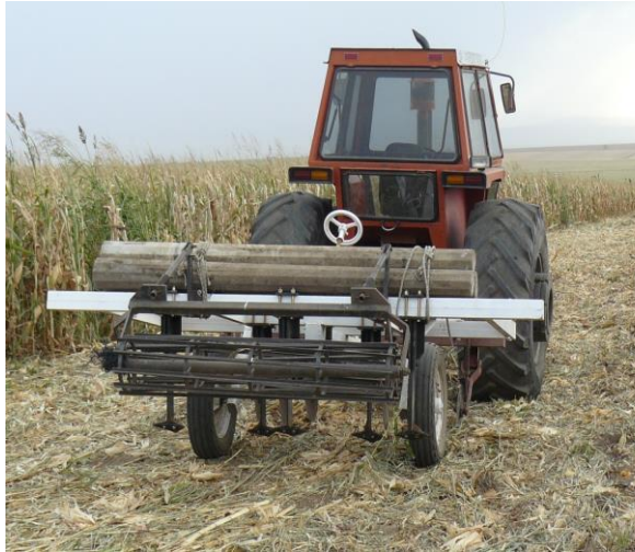
Figura 4: Vista posterior del conjunto tractor-escarificador alado-rolo, utilizado en el trabajo.
