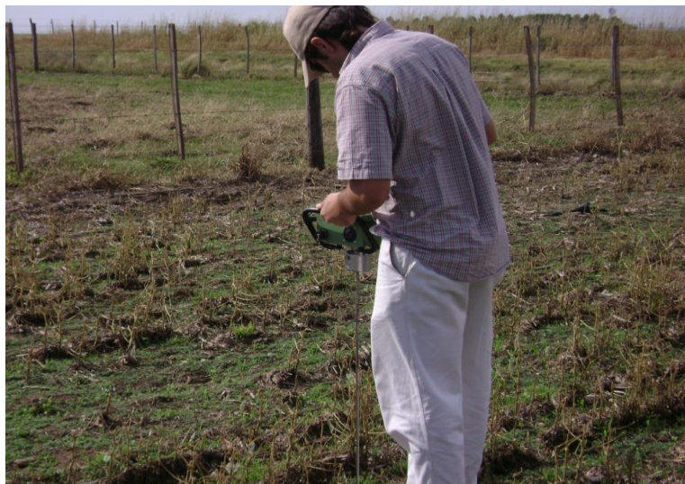
Figura 9: Determinación de la resistencia a la penetración, a través del penetrómetro computarizado.
