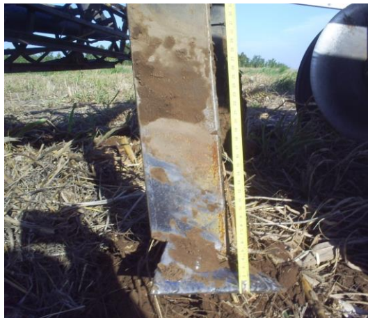
Figura 6: Vista lateral de una de las rejas del escarificador, con el detalle de la profundidad de trabajo de la herramienta.
