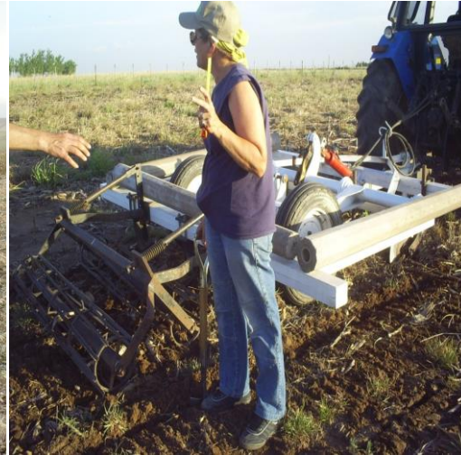
Figura 5: Escarificador alado en funcionamiento, con el detalle del efecto de los rolos posteriores sobre la superficie del suelo.
