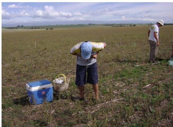
Figura 11: Toma de muestras con el barreno, para la determinación del contenido de humedad, a través del método gravimétrico.
