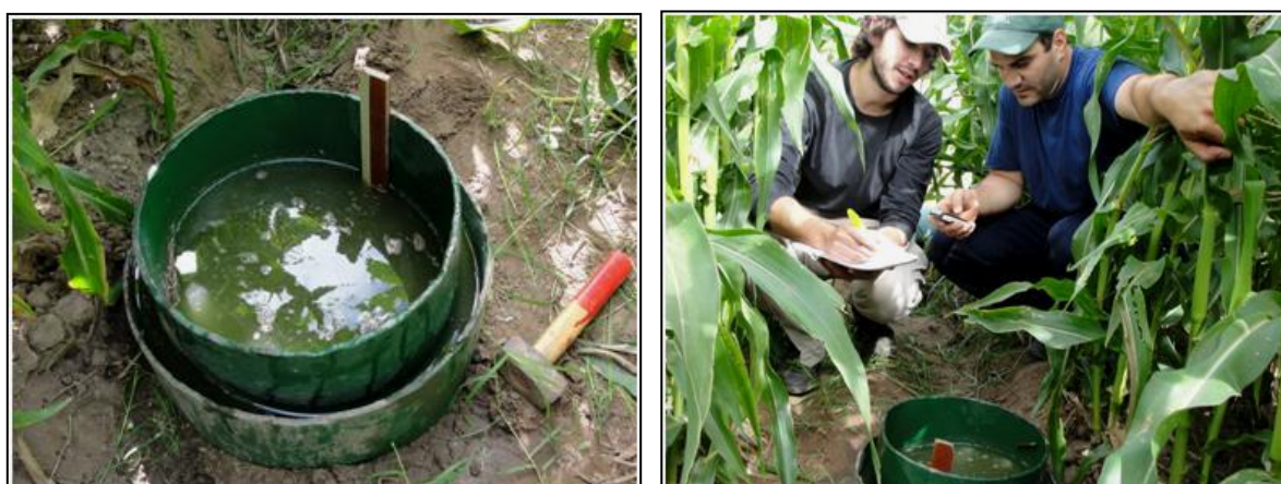
Figura 9: Ensayos de infiltración con doble anillo. UNRC. Río Cuarto. Córdoba.
