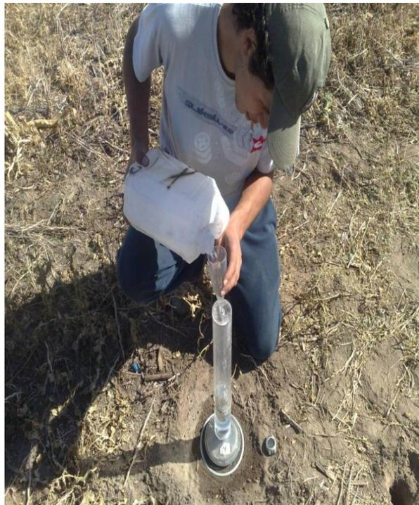
**Foto 14:** Detalle de la carga de agua al reservorio de agua durante la medición.
