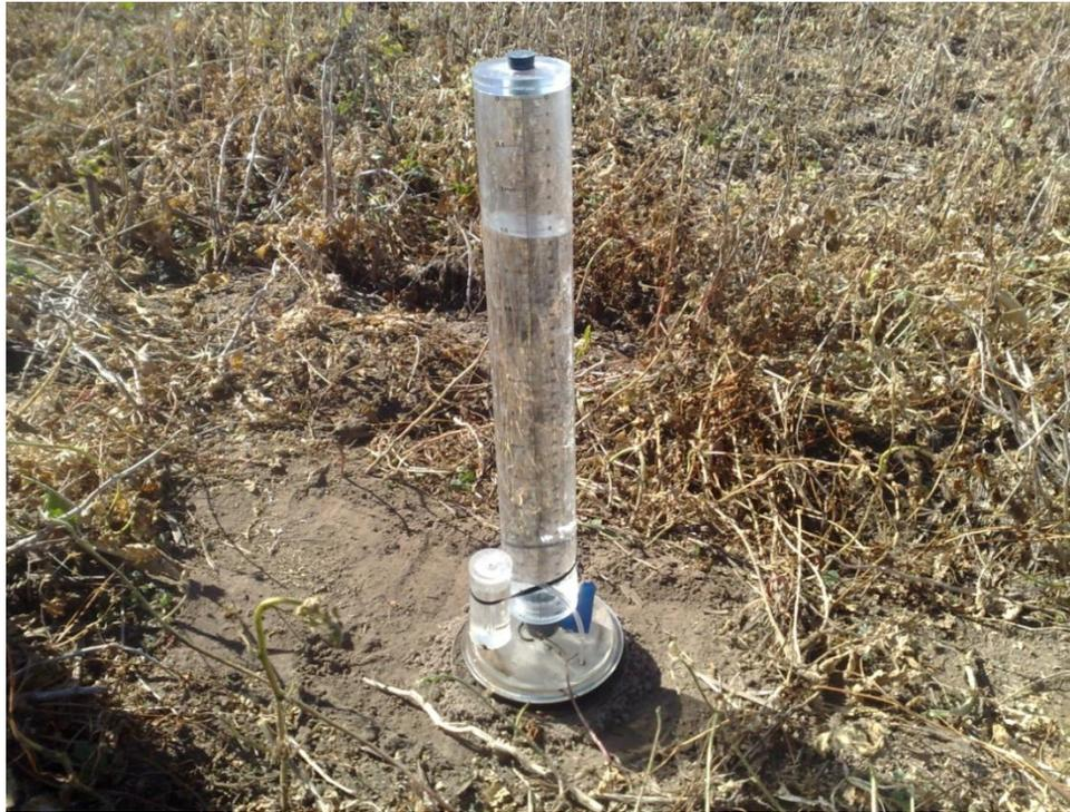
**Foto 13:** Detalle de anillo enrasador, arena tamizada fina y permeámetro a disco.
