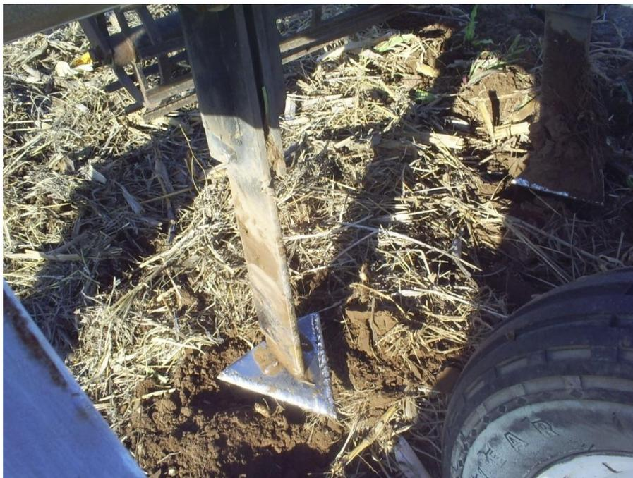
**Foto 2:** Vista detallada del conjunto reja-timón del escarificador alado
