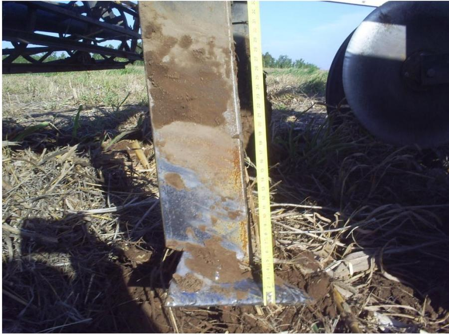
**Foto 3:** Vista lateral de una de las rejas del escarificador, con el detalle de la profundidad de trabajo de la herramienta
