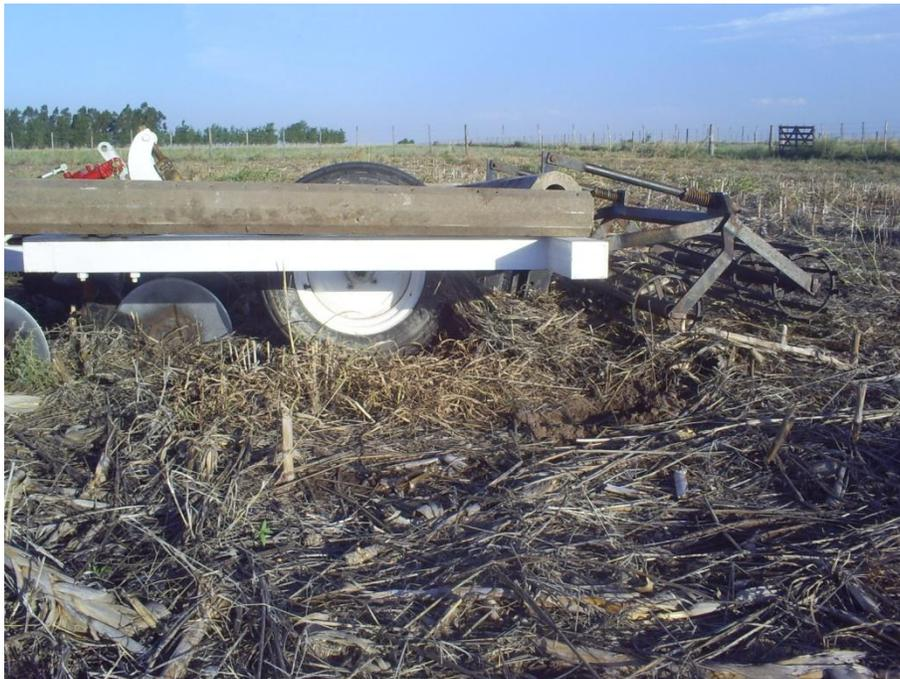
**Foto 4:** Vista lateral del escarificador alado en funcionamiento.
