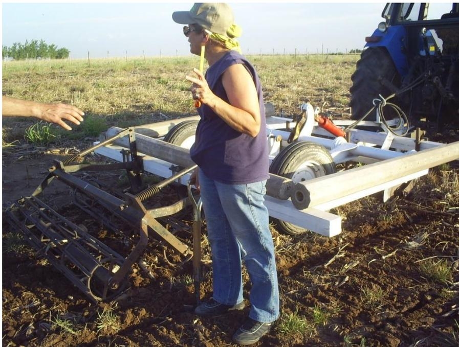
**Foto 1:** Escarificador alado en funcionamiento, con el detalle del efecto de los rolos posteriores sobre la superficie del suelo.
