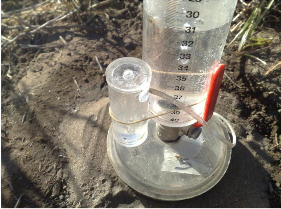
**Foto 15:** Detalle del Vaso de Tensión.
