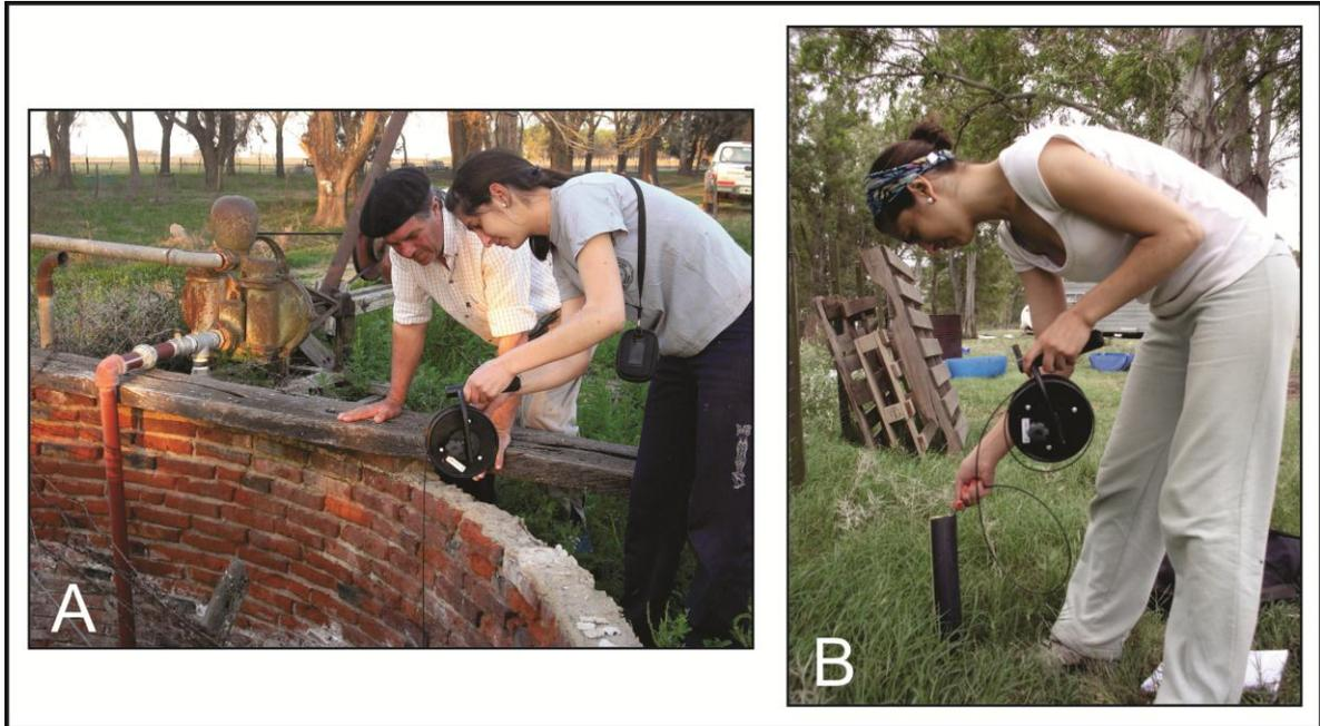
Figura VII.9. Medición de niveles estáticos del acuífero freático. A) Con sonda en antepozo de gran diámetro revestido con ladrillos. B) Con sonda en freatímetro realizado de PVC .
