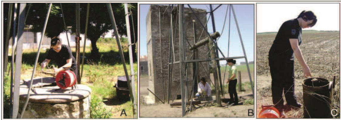
Figura 5.6: Medidas de campo de niveles estáticos. A-B- Antepozos de molinos C-Perforación.
