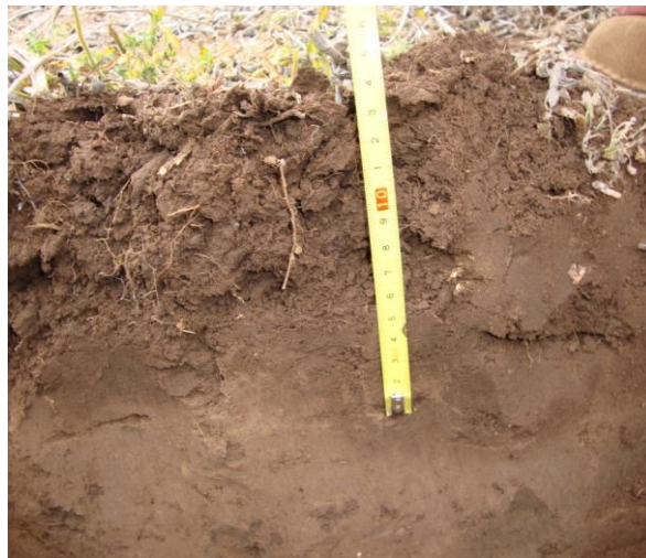
Foto 2: Pared expuesta de la calicata para el diagnóstico de la zona compactada en el perfil del suelo.
