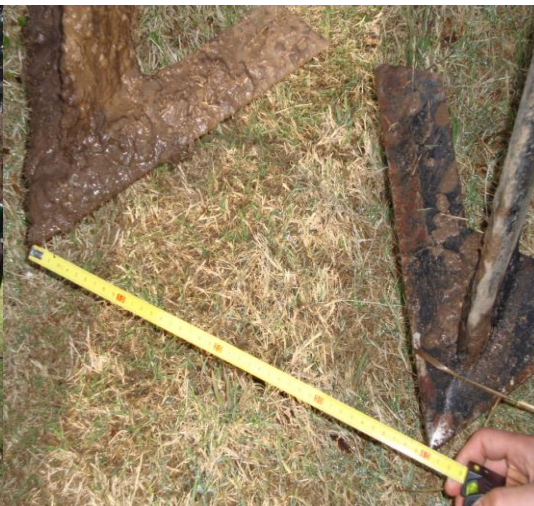
Foto 4: Vista detallada de la reja del paratill indicando el distanciamiento entre timones, siendo de aproximadamente de 40 cm.
