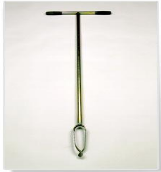
Foto 8 “b”: Detalle del barreno para la toma de muestras de suelo hasta el metro de profundidad.
