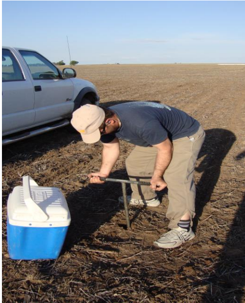
Foto 8 “a”: Toma de muestras con el barreno para la determinación del contenido de agua según método volumétrico.
