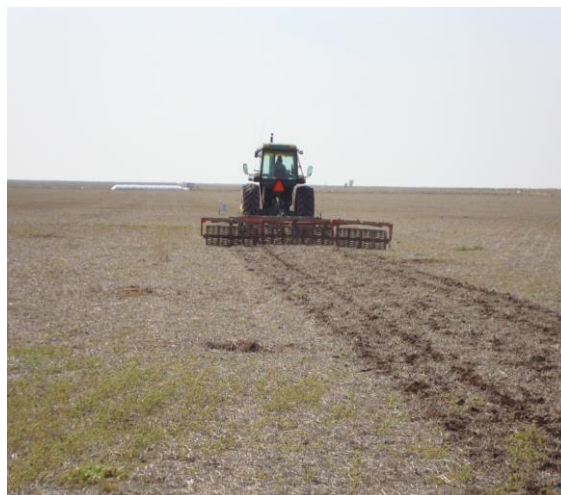
Foto 6: Vista posterior del rolo dispuesto detrás del paratill con el objetivo de cerrar los surcos originados por las rejas de dicha herramienta, reacondicionar la superficie del suelo y el rastrojo.
