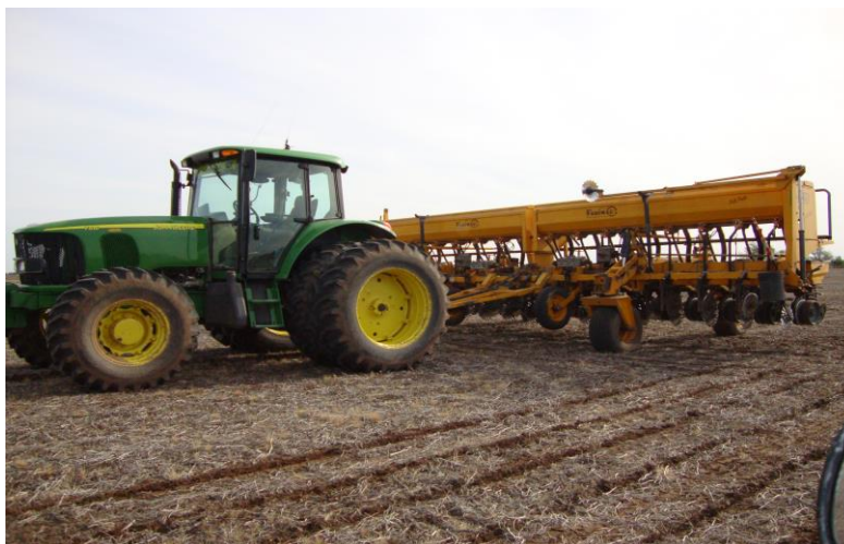
Foto 7: Vista lateral del conjunto tractor “John Deere” y sembradora de siembra directa marca Fabimag modelo Multiplanter, neumática, de 16 surcos a 0.52 m entre líneas de siembra.
