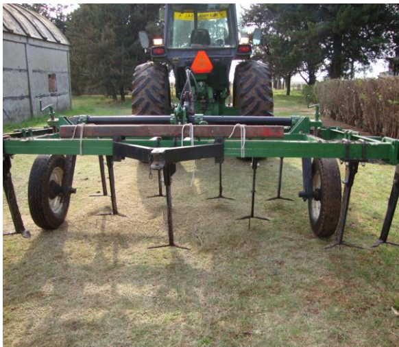
Foto 3: Vista posterior del paratill de fabricación artesanal, utilizando un antiguo chasis de arado cincel.
