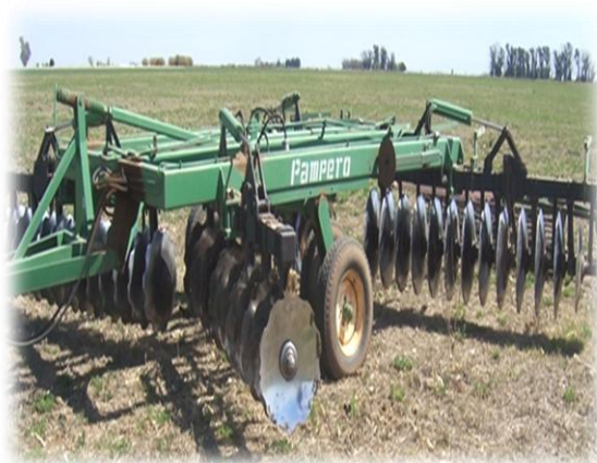
Figura 9: Vista lateral de la rastra doble acción.
