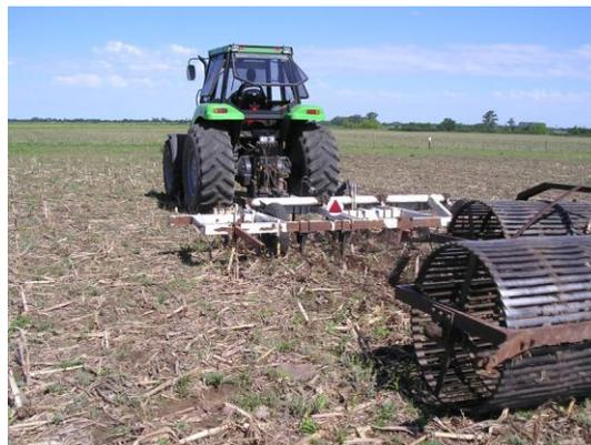
**Fotografía 2: Imagen del momento de realización de la labranza de descompactación subsuperficial en el área de estudio.**
