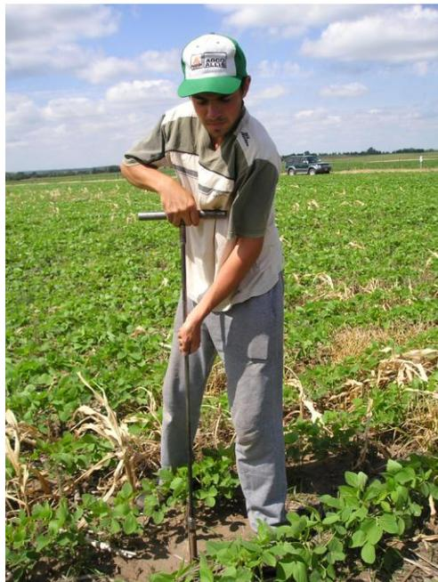
**Fotografía 5: Imagen de toma de muestras de suelo por medio de barreno, para determinación de contenido hídrico.**
