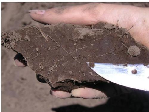
**Fotografía 8: Bloque angular de caras de ruptura lisas, sin porosidad visible, con presencia de raíces sobre los planos de debilidad.**
