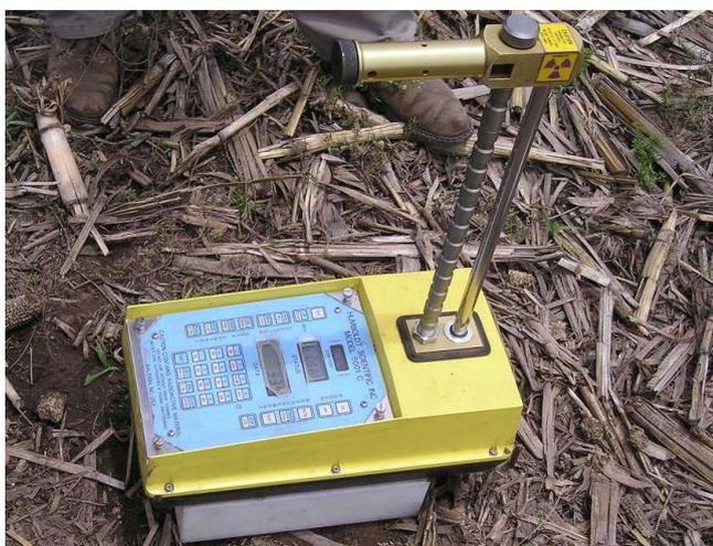
**Fotografía 4: sonda de rayos gamma utilizada para la determinación de densidad aparente (DAP).**
