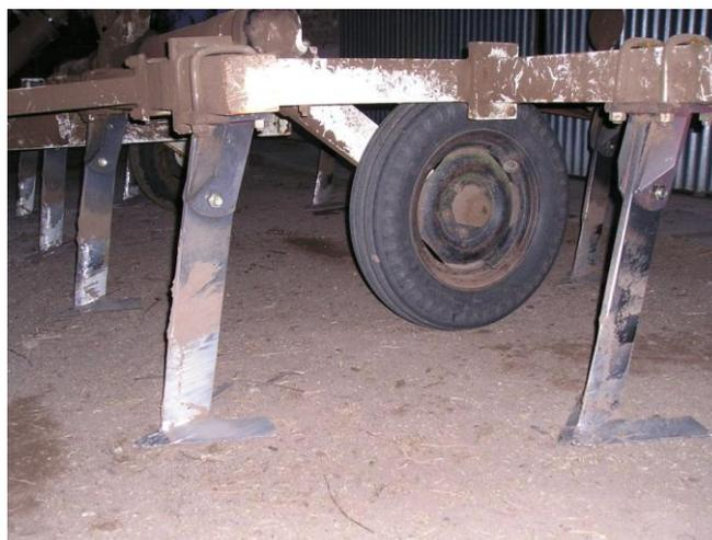
**Fotografía 3: Detalle de la reja alada sobre el montante utilizado para el tratamiento “LDS”.**
