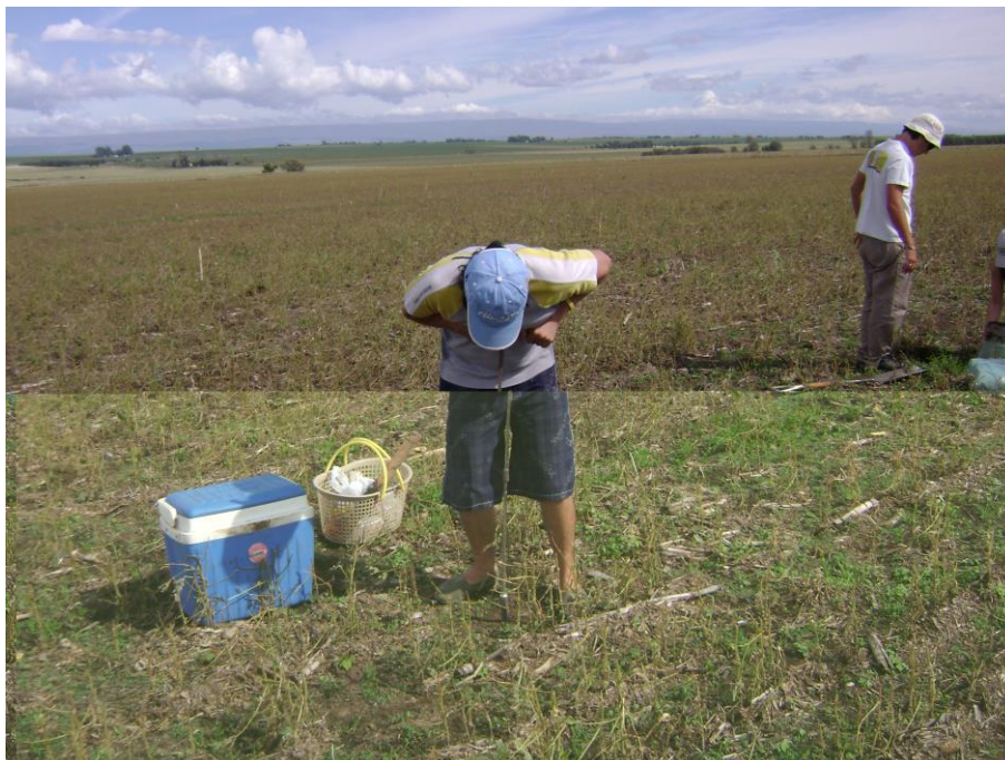
Foto 14: Toma de muestras con el barreno, para la determinación del contenido de humedad, a través del método gravimétrico.
