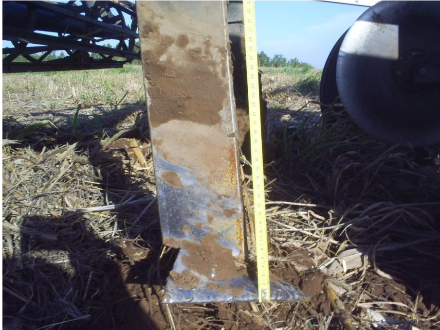
Foto 5: Vista lateral de una de las rejas del escarificador, con el detalle de la profundidad de trabajo de la herramienta.
