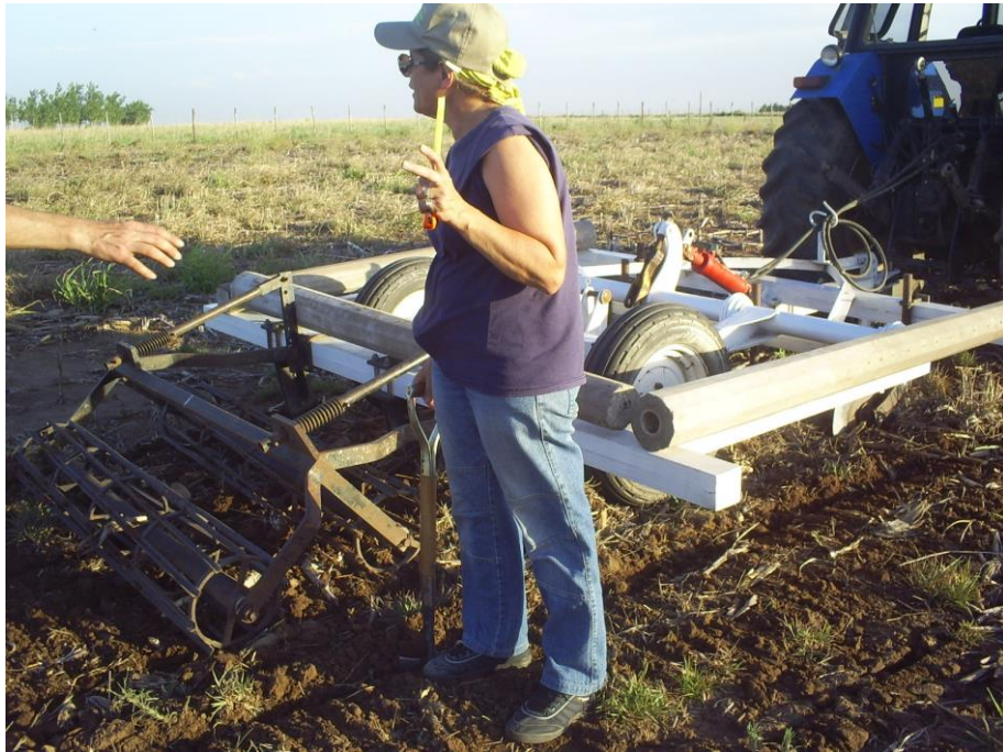
Foto 7: Escarificador alado en funcionamiento, con el detalle del efecto de los rolos posteriores sobre la superficie del suelo.
