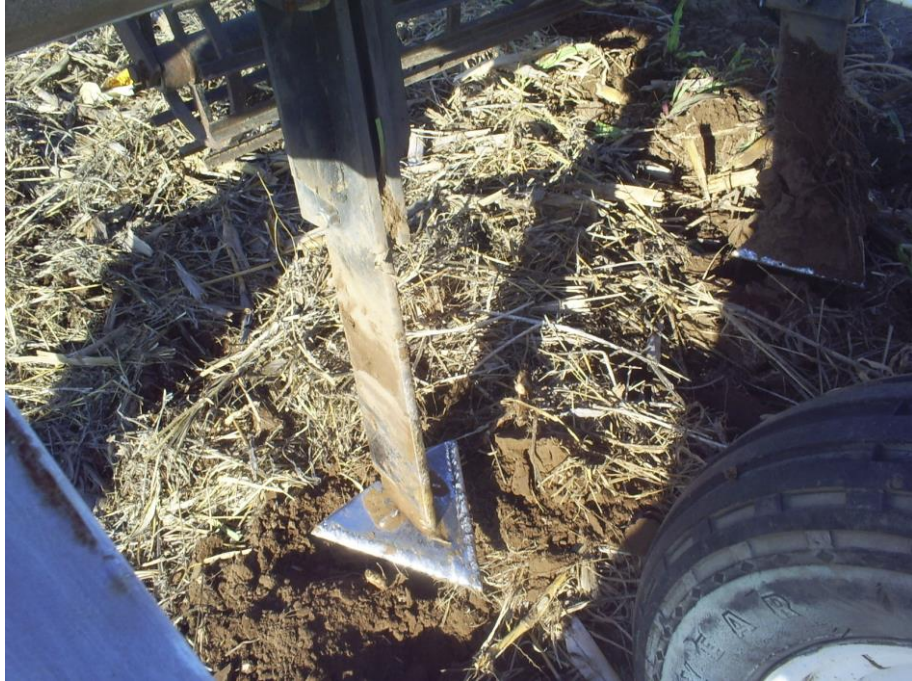
Foto 3: Vista detallada del conjunto reja-timón del escarificador alado.
