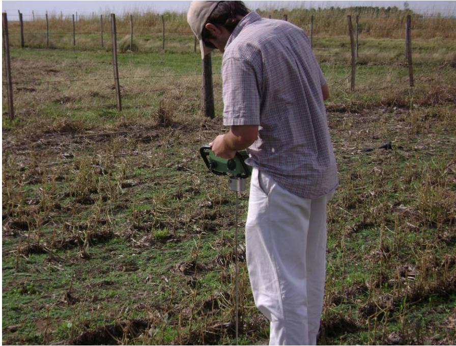
Foto 15: Determinación de la resistencia a la penetración, a través del penetrómetro computarizado.
