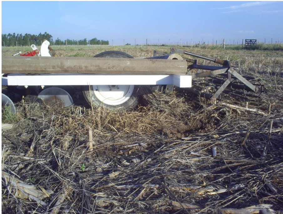
Foto 9: Vista lateral del escarificador alado en funcionamiento.
