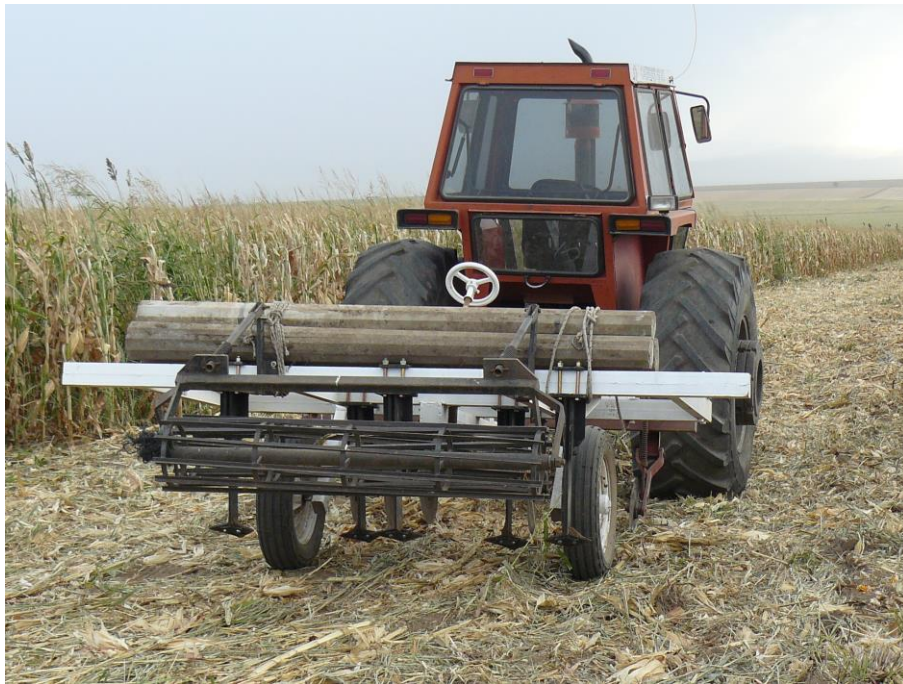
Foto 1: Vista posterior del conjunto tractor-escarificador alado-rollo, utilizado en el trabajo.
