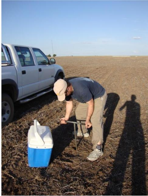
**Foto 9 “b”:** Toma de muestras con el barreno para la determinación del contenido de agua según método gravimétrico.
