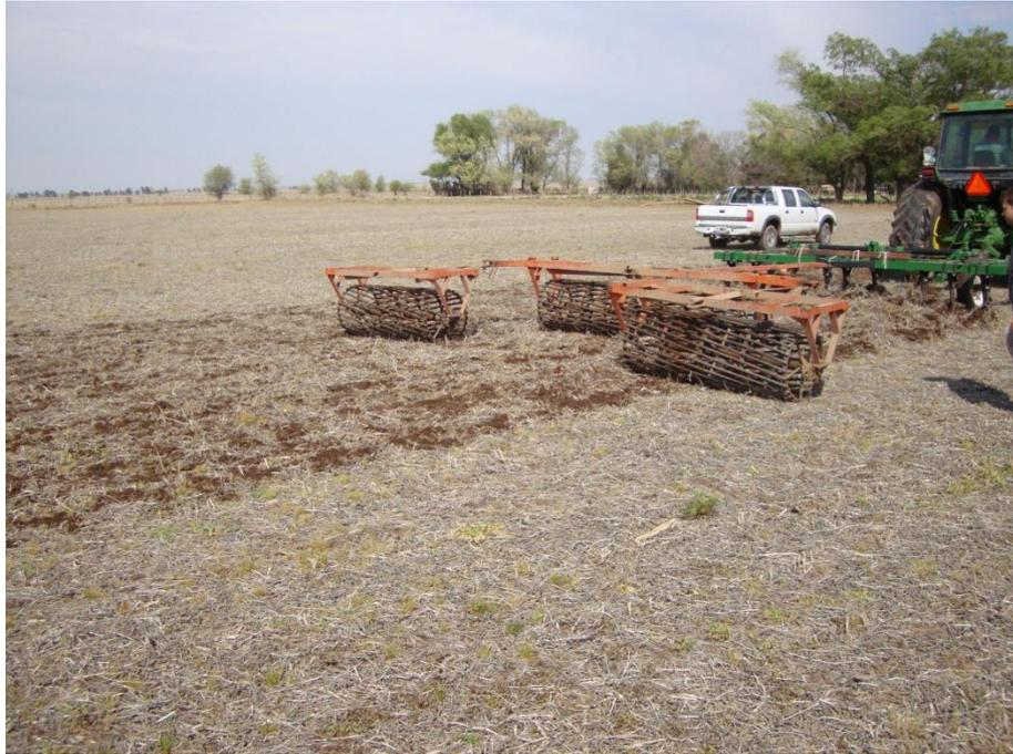
**Foto 7: Vista lateral del conjunto tractor - Paratill - rolo trabajando.**
