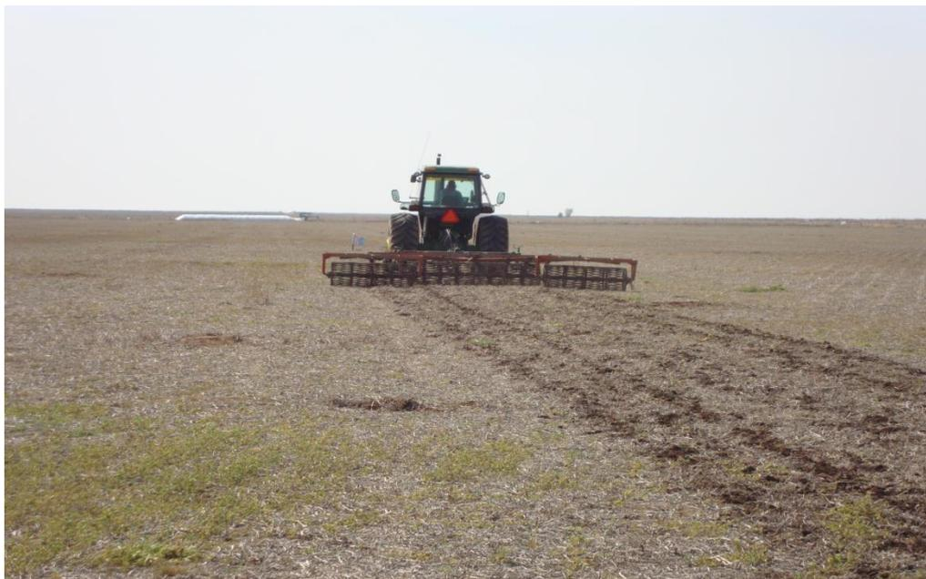
**Foto 6: Vista posterior del rolo dispuesto detrás del “Paratill” con el objetivo de cerrar los surcos originados por las rejas de dicha herramienta, reacondicionar la superficie del suelo y el rastrojo.**
