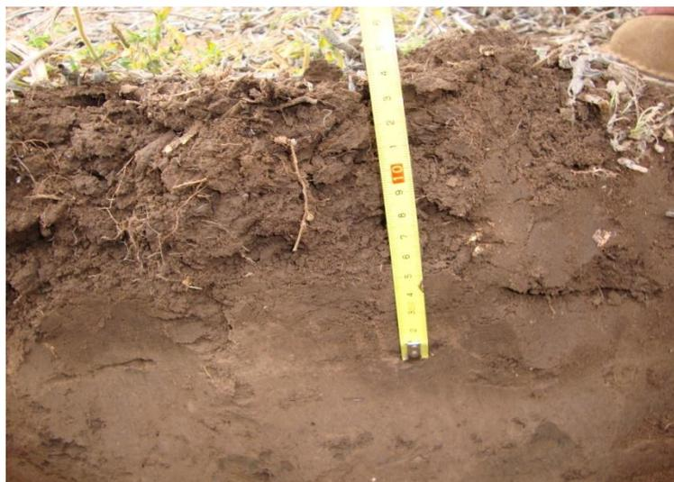
**Foto 2: Pared expuesta de la calicata para el diagnóstico de la zona compactada en el perfil.**
