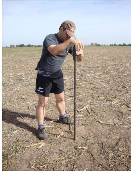
**Foto 9 “a”:** Determinación de la resistencia mecánica mediante Penetrómetro a golpes.
