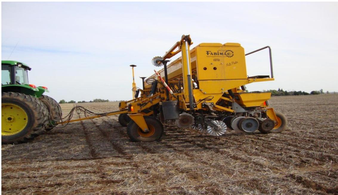
**Foto 8: Vista lateral de sembradora directa marca Fabimag modelo Multiplanter, neumática, de 16 surcos a 0.52 m entre líneas de siembra.**
