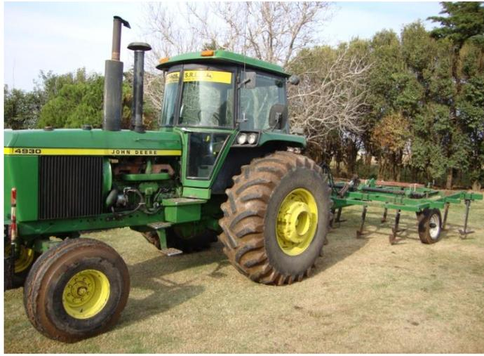
**Foto 3: “Paratill” de fabricación artesanal, utilizando un antiguo chasis de arado cincel.**
