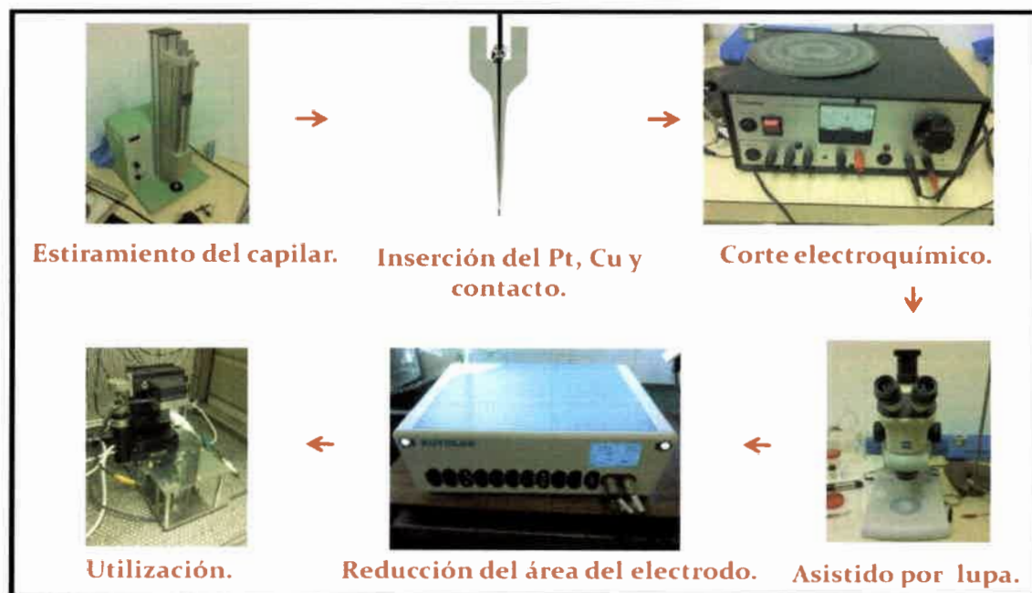
Figura A1. Esquema del proceso de fabricación de los nanoelectrodos.
