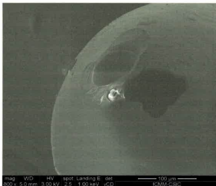
Figura A9. Imagen SEM, 800 X. Extremo del capilar de vidrio, con el Pt inserto y recubierto del polímero aislante. Los dos áreas oscuras, son burbujas de aire, atrapadas en el vidrio del capilar.
