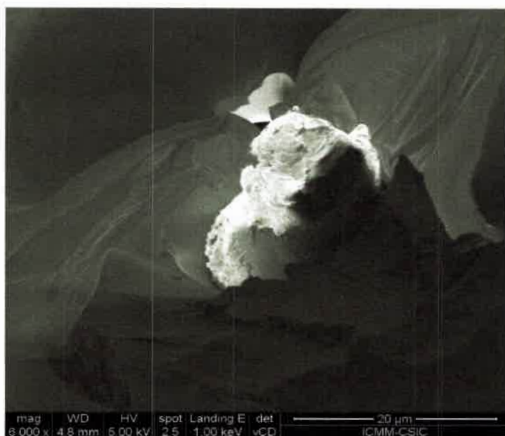
Figura A10. Imagen SEM, 6000 X. Extremo del capilar de vidrio con el Pt inserto y recubierto de polímero aislante. Se pueden observar los efectos generados por el corte electroquímico.
