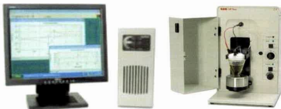
Figura 3.7. Potenciostato/galvanostato BAS, Modelo EPSILON con su módulo de agitación, ambos con control desde la computadora.
