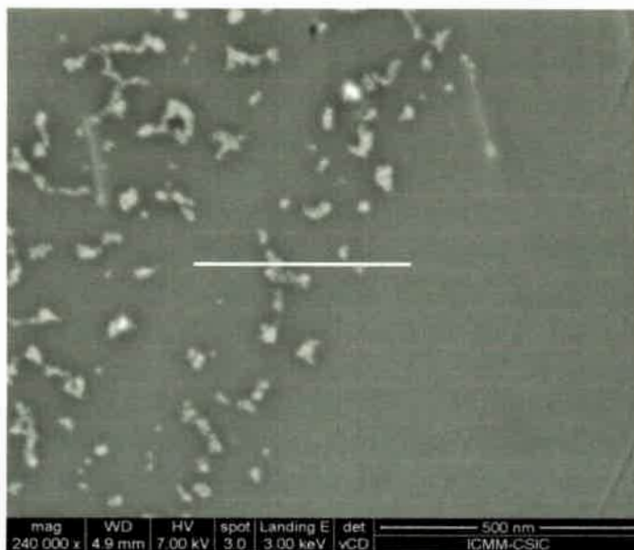
Figura A27. Imagen SEM 240.000 X – Placa de oro con depósito de npAu de \phi \approx 11 nm. La barra blanca representa, a modo de ejemplo, una línea sensada con el microscopio de barrido electroquímico.
