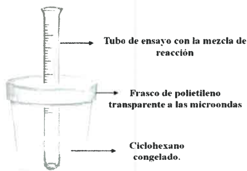
Figura 30. Sistema de enfriamiento.
