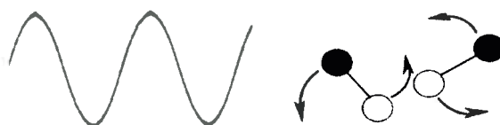
Figura 37. Rotación dipolar: los dipolos oscilan de acuerdo al campo eléctrico aplicado.
