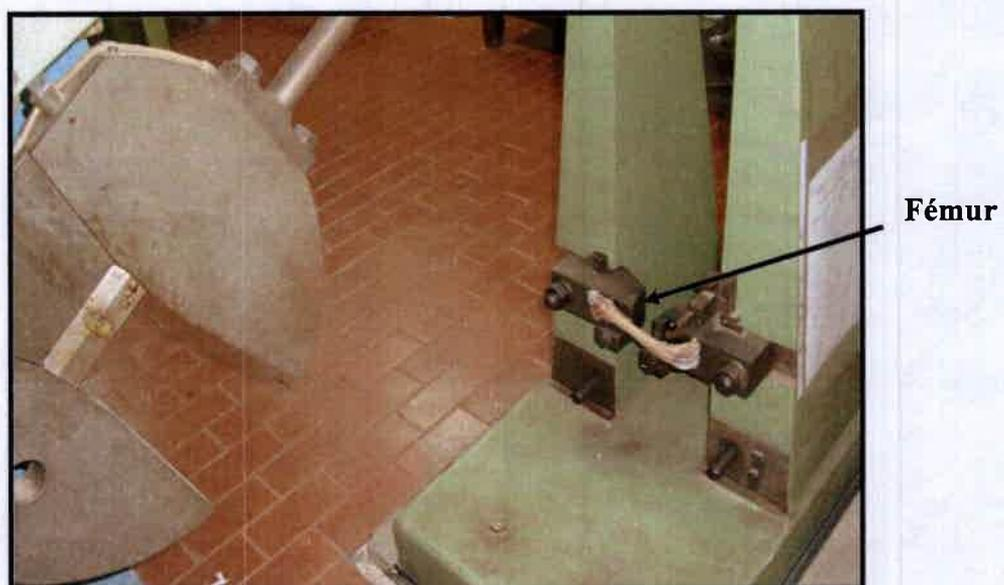
**Fig. 22.** Péndulo elevado y colocación del material de impacto (fémur derecho).
