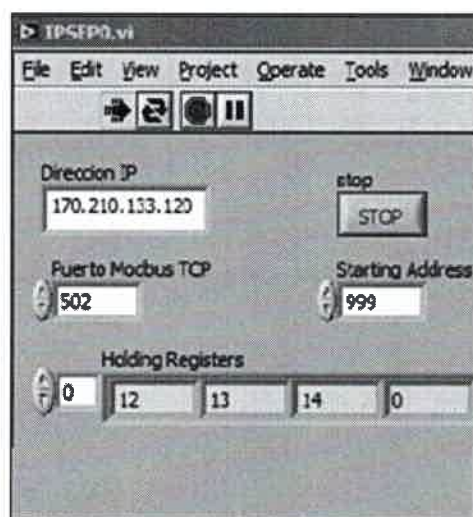
Figura 4-9 - Panel frontal de una aplicación cliente Modbus TCP en Labview
