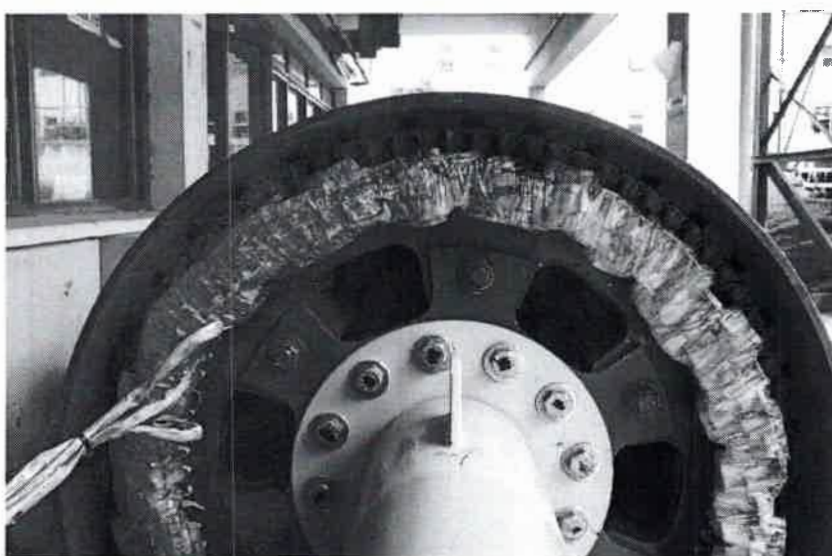
Figura 6.2: Generador montado en el banco de ensayos.
