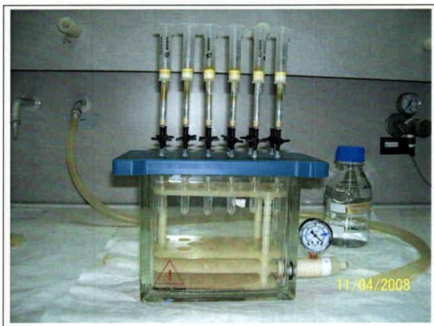
Fig. 8. Bomba de vacío con las columnas montadas, en esta etapa las columnas C18 se colocan sobre las columnas OASIS para recolectar las distintas fracciones.
