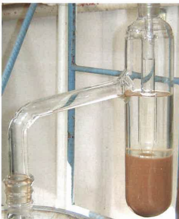
Figura 15: EH de A. saturoioides obtenido por extracción líquido-líquido
