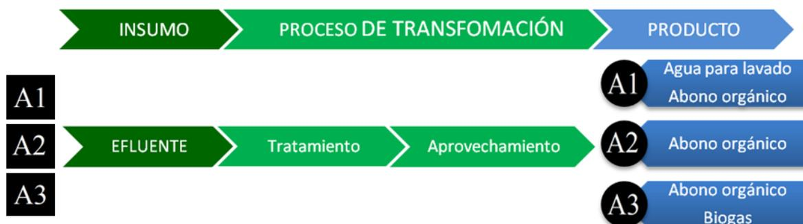
**Ilustración 3. Esquema de sistema de manejo de efluentes.**
