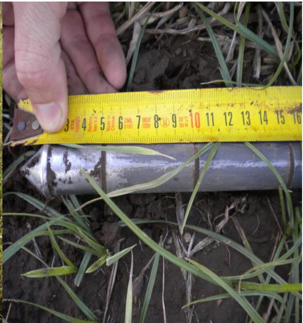
**Figura 13:** Vista en detalle de la punta cónica y los surcos acanalados cada 5 cm.
