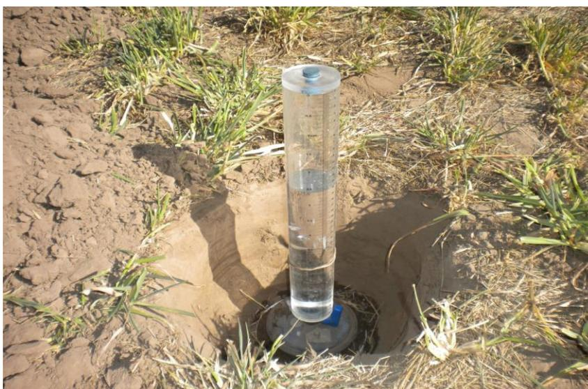
**Figura 8:** Vista del permeámetro ubicado en el horizonte subsuperficial.
