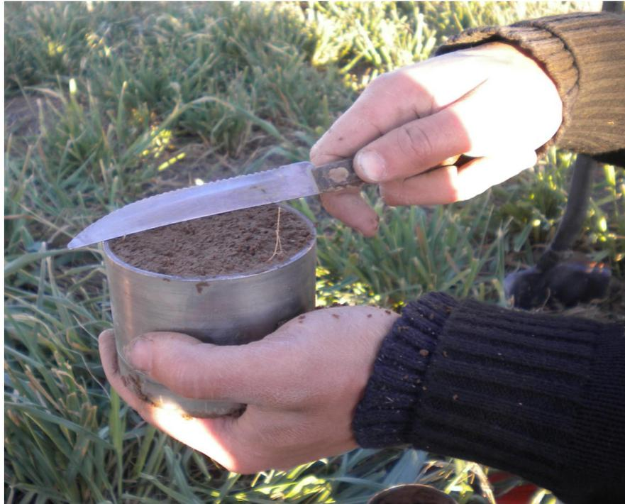
**Figura 11:** Vista del nivelado al ras del borde del cilindro interno, con la ayuda de un cuchillo.
