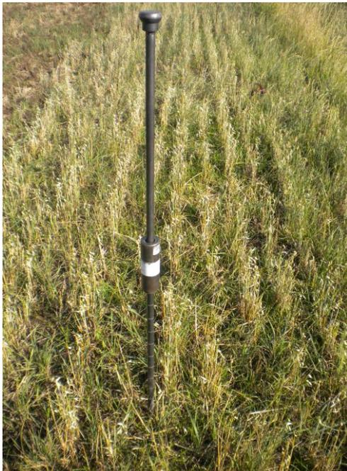
**Figura 12:** Vista del penetrómetro con la pesa en el lugar más bajo.
