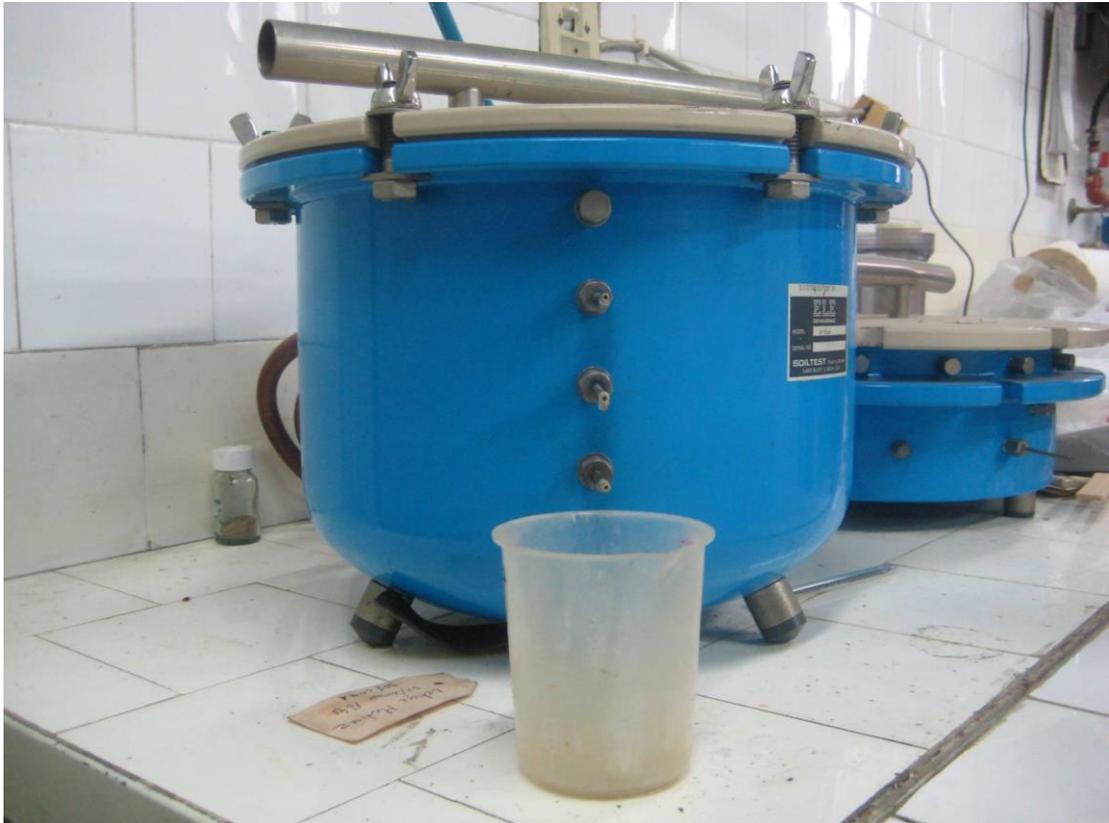
**Figura 15:** Vista en detalle de la olla de presión, con su tapa y sus respectivas tuercas mariposas.
