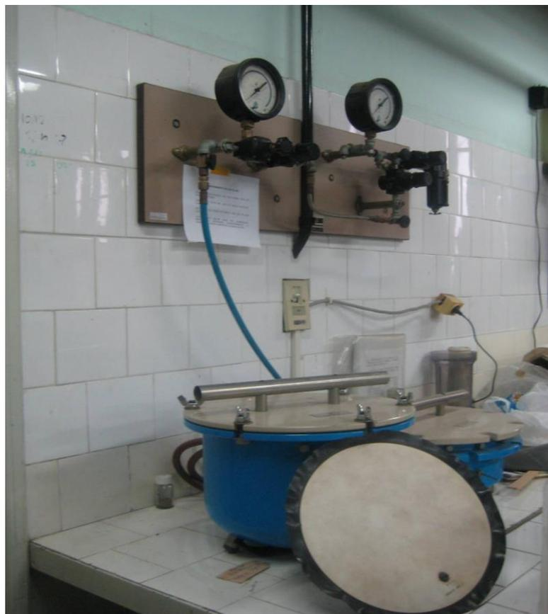
**Figura 14:** Detalle del plato de cerámica, vista de la olla y de los manómetros.
