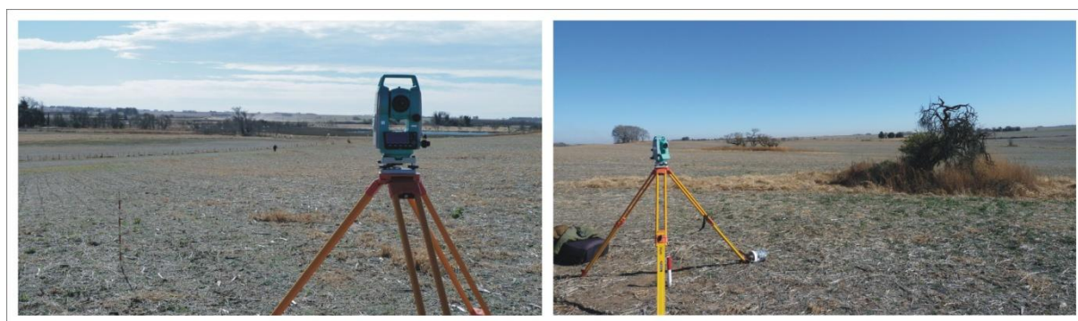
Figura 4.4. Estación Electrónica Total utilizada para el relevamiento de perfiles topográficos.
