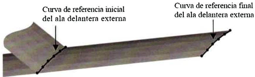
Figura 3-8: Curvas de referencia que delinear la geometría del ala delantera externa.
