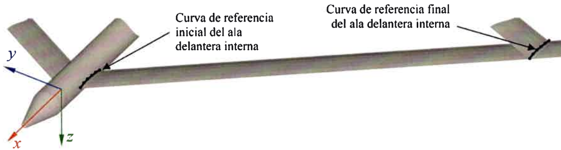
Figura 3-12: Curvas de referencia que delinear la geometría del ala delantera interna.
