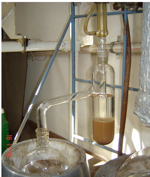
Figura 6: Extractor líquido-líquido para solventes menos densos que el agua
