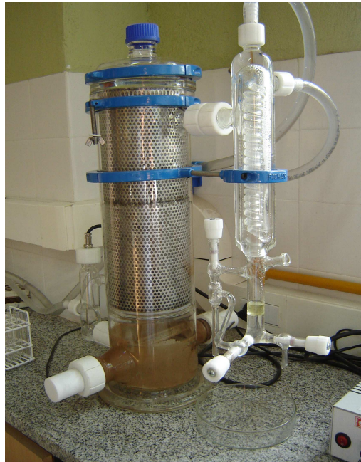
Figura 7: Hidrodestilador con trampa tipo Clevenger para la extracción de AE
