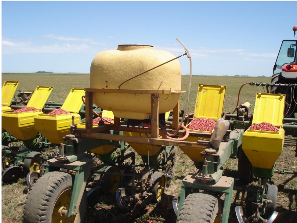
Figura N°1: “Kit” inoculador instalado en sembradora, durante siembra de maní
