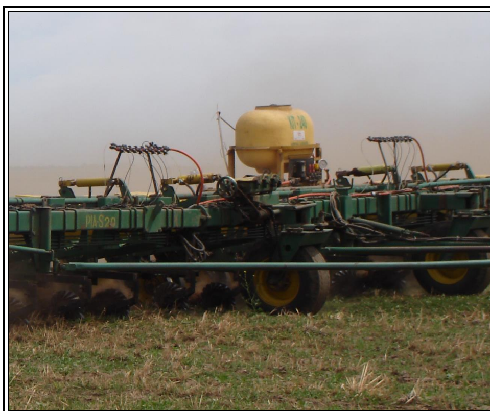
Fotografía 2: Detalle de “kit” inoculador y sistema distribuidor de mangueras en sembradora marca Pierobon PIA
