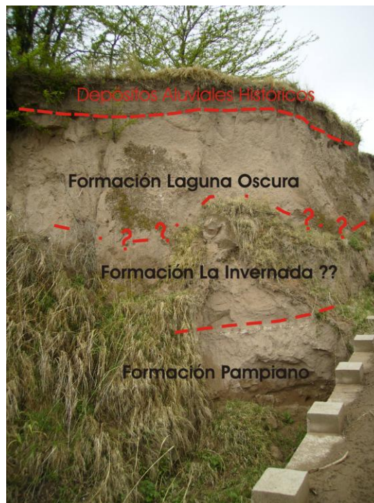
Figura Nº 5.1.1.e: Descripción del Perfil Tipo, en la base la Formación Pampiano, le continúan la Formación La Invernada?? y por encima la Formación Laguna Oscura, rematando la secuencia Depósitos Aluviales Históricos.
