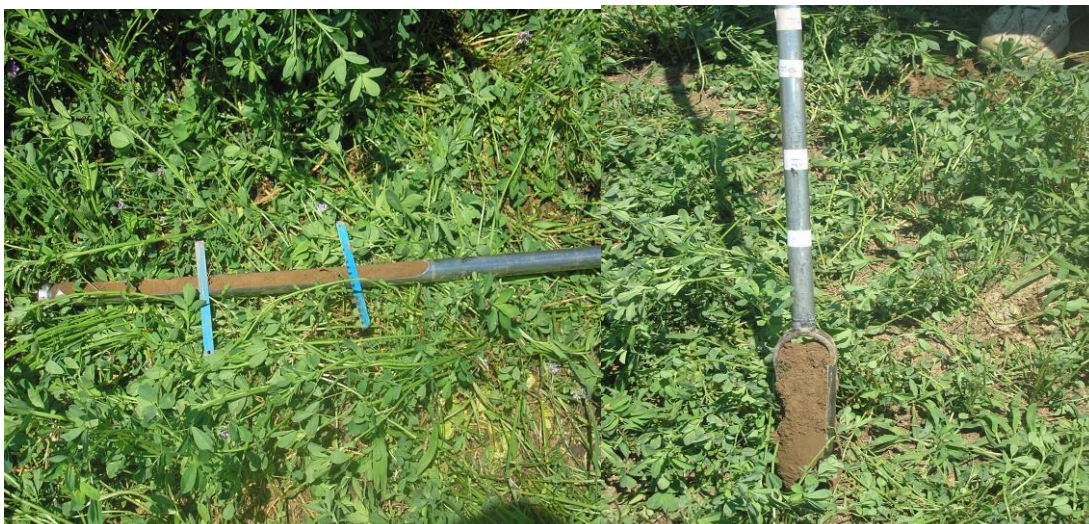
Figura 4. Barrenos utilizados para la extracción de muestras
