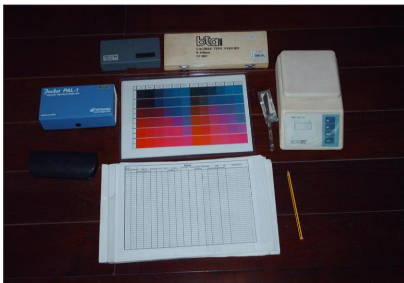
Figura 3: Materiales utilizados para realizar los registros: de izquierda a derecha refractómetro, presiómetro, calibre, balanza y escala de color (al centro).
