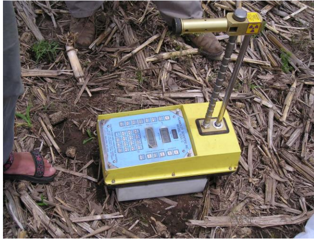
Foto 5: Imagen de la sonda de rayos gamma utilizada para evaluar Densidad Aparente.
