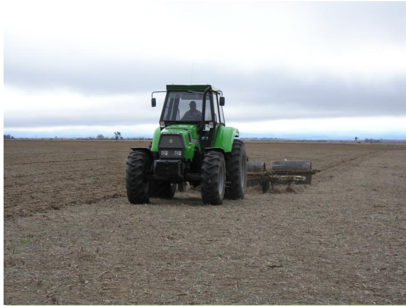
Foto 2: Imagen del equipo tractor/descompactador/rolo, en el sitio experimental.
