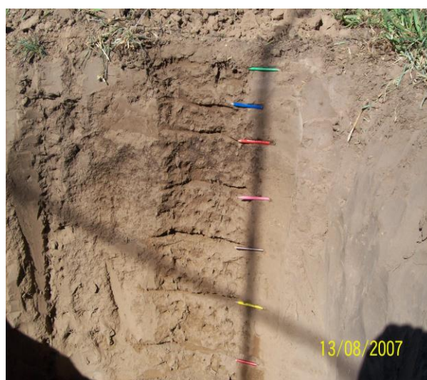
Figura 2 – Calicata donde se observan los diferentes horizontes en el perfil del suelo.
