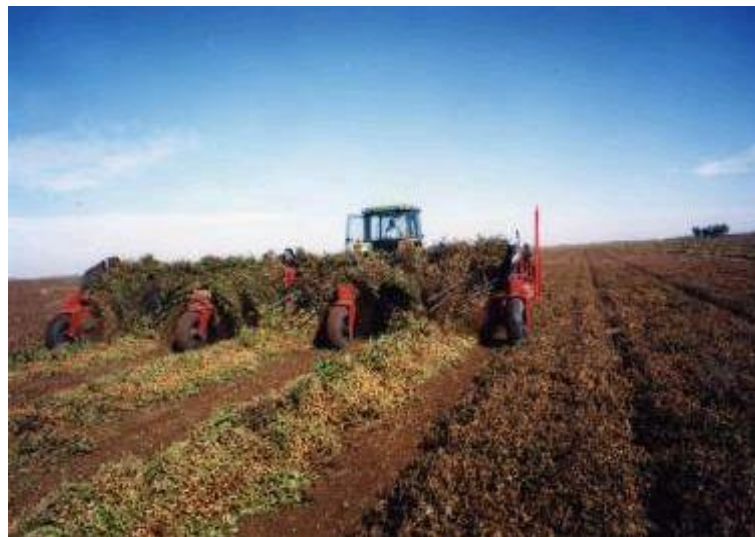
Figura N° 5: Arrancadora de maní de 12 x 3, de origen nacional. Fuente: INTA PRECOP, 2008
