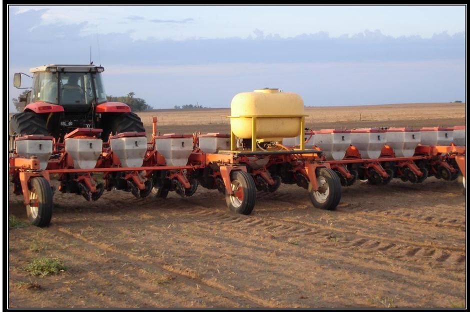
Fotografía 1: Sembradora marca Fercam de 20 surcos con “kit” inoculador.
