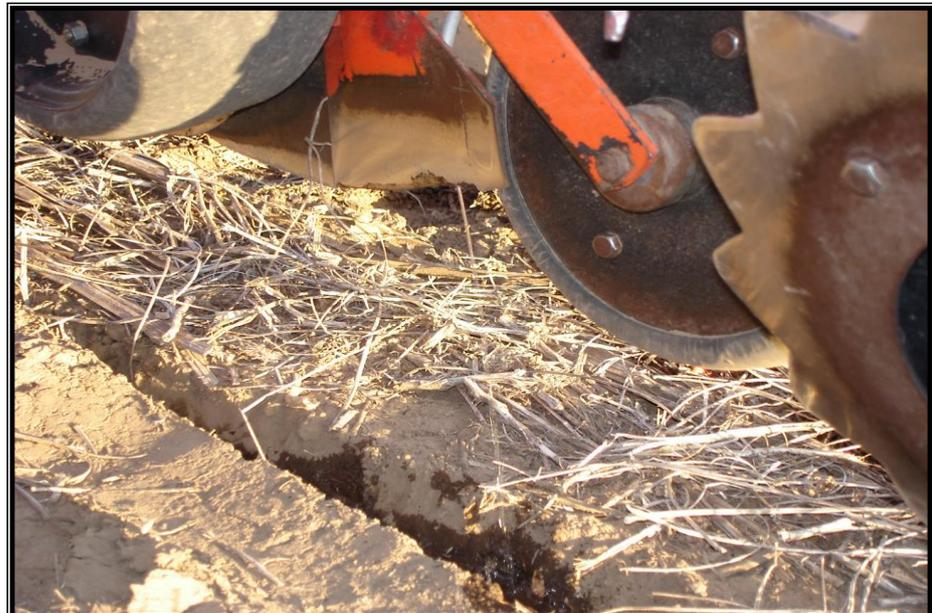
Fotografía 4: Detalle de la aplicación del inoculante en el fondo del surco con la sembradora levantada, los picos se encuentran ubicados detrás del caño de bajada de la semilla.
