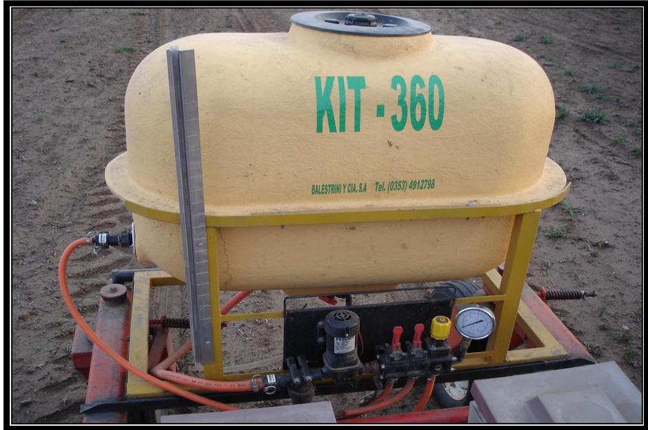
Fotografía 3: Tanque contenedor del caldo inoculante y agua, bomba y manómetro.
