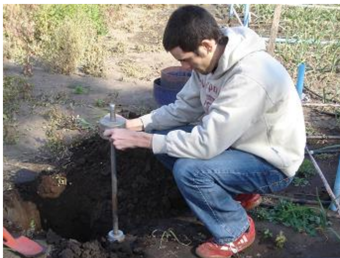
Figura 30: Obtención de muestras para el cálculo de Densidad Aparente. UNRC. Río Cuarto. Córdoba.
