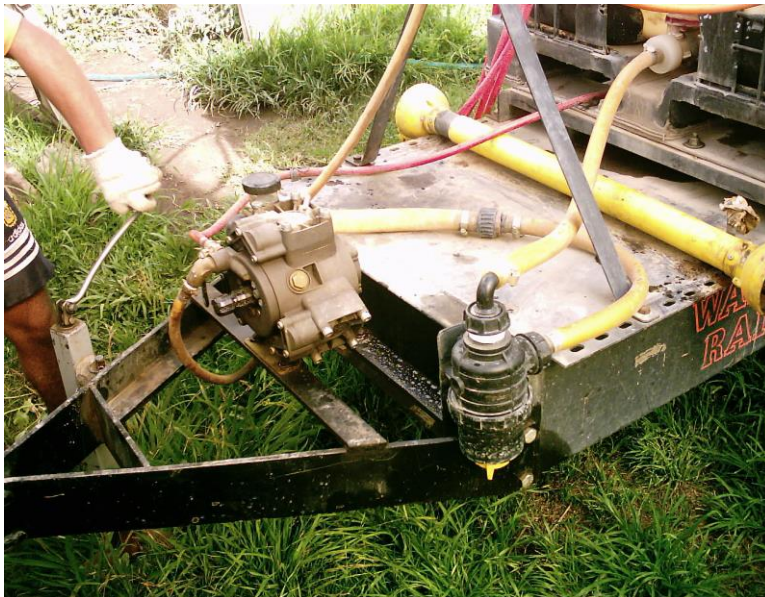
Foto 8: Bomba y filtro del equipo de pulverización
