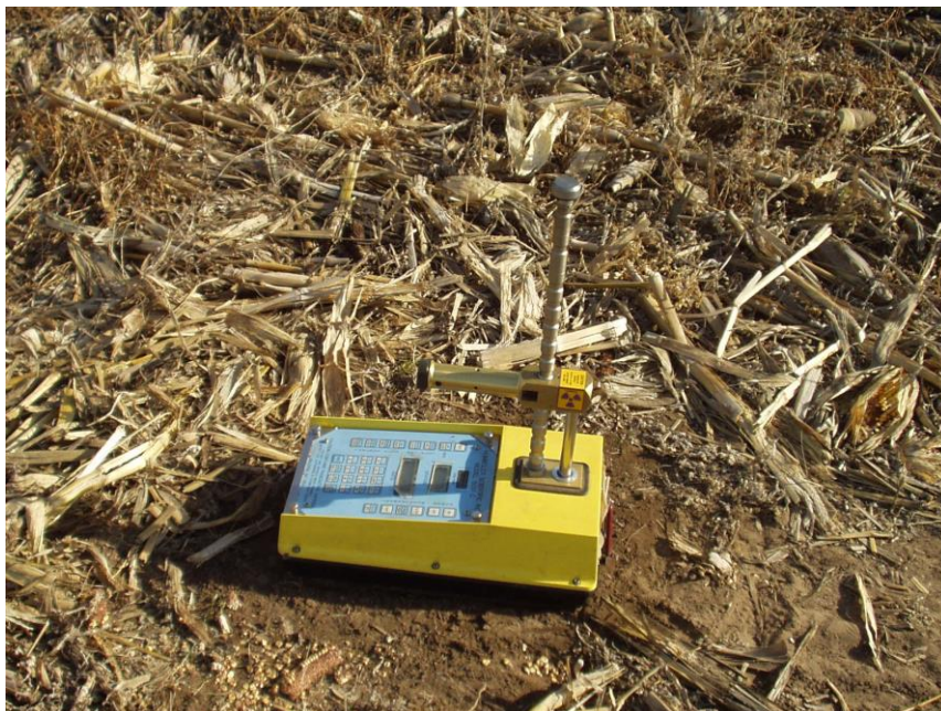
FOTO N° 7: Sonda de rayos gamma para la medición de la Densidad Aparente.
