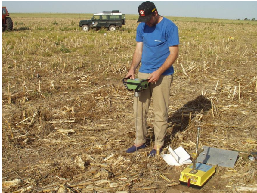
FOTO N° 8: Penetrómetro computadorizado para la medición de la Resistencia Mecánica.
