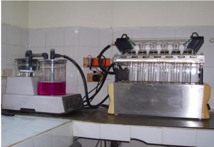
Figura 5: Digestor para Kjeldhal
