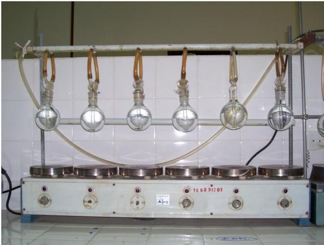
Figura 4: Digestor de fibras
