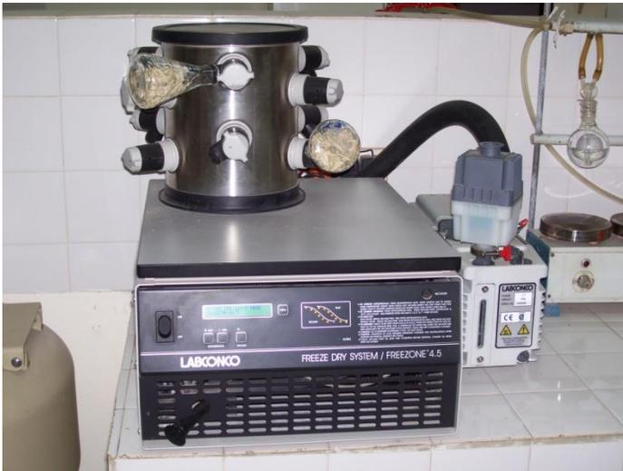
Figura 8: Liofilizador
